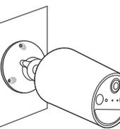
7. 動体検知のパフォーマンスを上げるため、カメラは地上から2~3m以上の高さに設置することをおすすめします。
